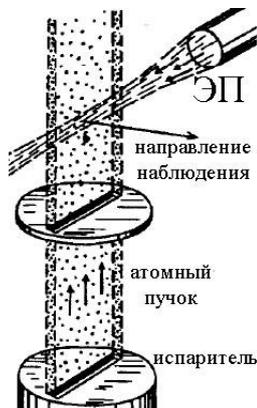
Рис. 8.8. Устройство источника света с атомным пучком
