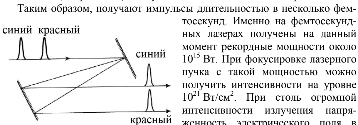
Рис. 9.11. Пара дифракционных решеток, образующих оптическую систему, обладающую отрицательной дисперсией ( dv_{гр}/d\lambda < 0 )
