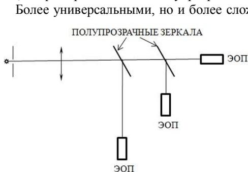
Рис. 11.20. Оптическая схема многокадровой регистрации
