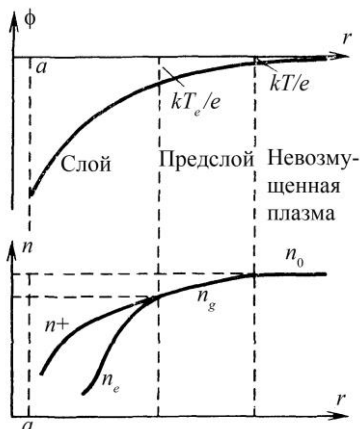
Рис. 11. Распределения потенциалов и плотностей электронов и положительных ионов около отрицательного зонда
