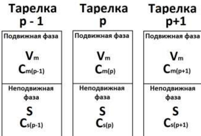
**Рис. 5.** Три последовательные теоретические тарелки [9].
