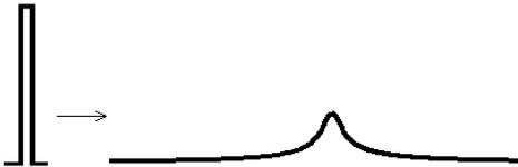
Рис. 8. Искажение импульса в линии, вызванное сильной дисперсией
