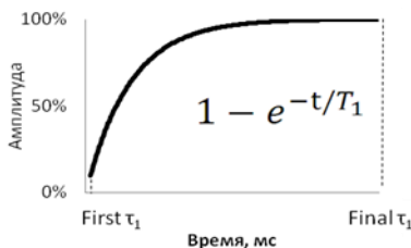
Рис. 11. Типичный вид экспериментальной зависимости продольной намагниченности от времени, получаемый при использовании импульсной последовательности насыщение–восстановление
