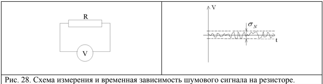
Рис. 28. Схема измерения и временная зависимость шумового сигнала на резисторе.
