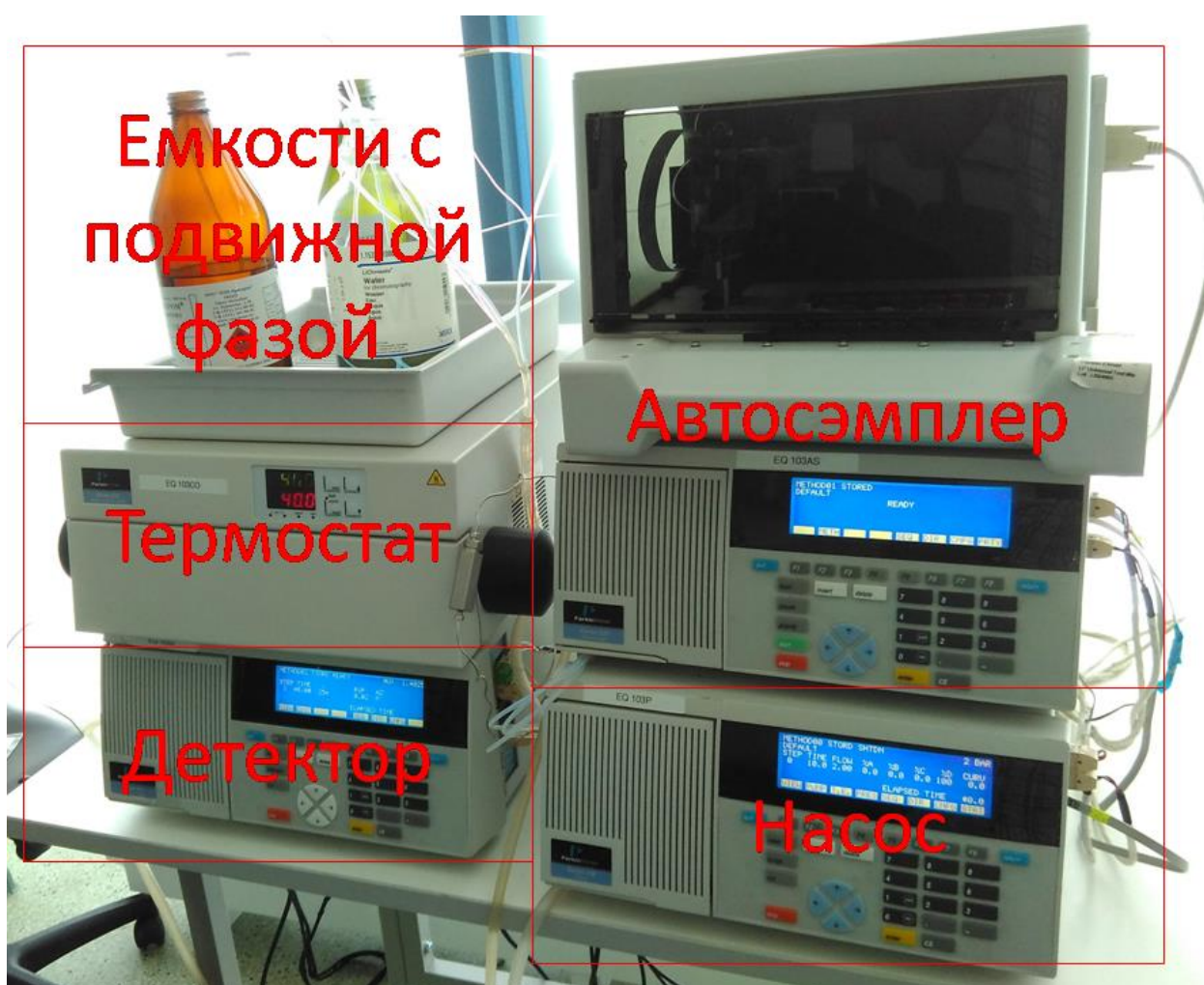
Рисунок 1. Основные компоненты ВЭЖХ системы PerkinElmer Series 200
