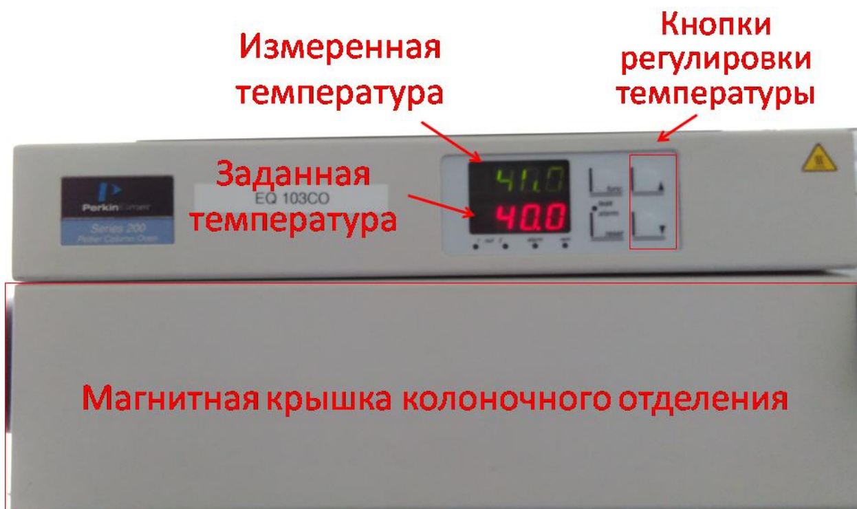
Рисунок 5. Общий вид колоночного термостата PE Series 200 Peltier Column Oven (передняя панель)
