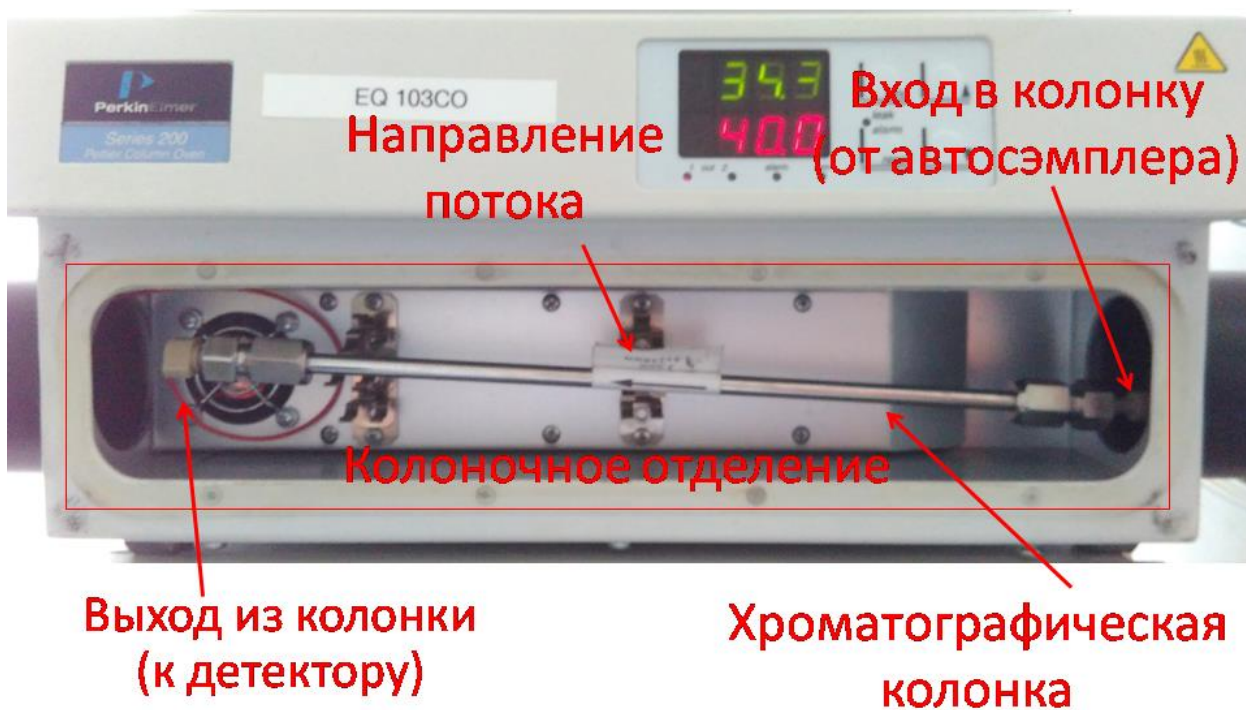
Рисунок 6. Колоночное отделение термостата PE Series 200 Peltier Column Oven
